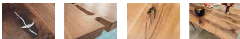
Zinn-Guss oder Epoxidharzfüllung für naturbelassene Äste und Risse
